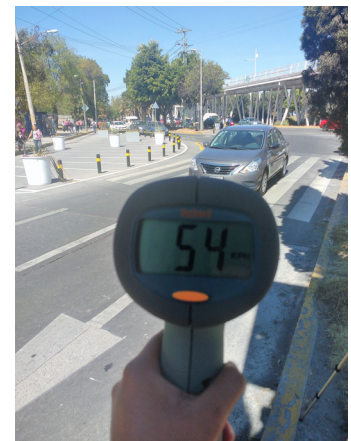
Foto: Identificación de velocidades en Puebla de Zaragoza, Puebla en México.
